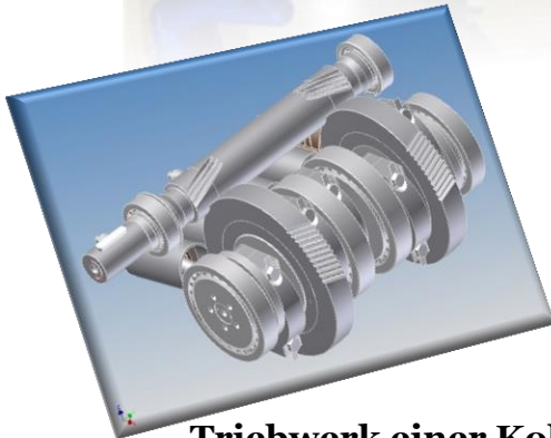
Triebwerk einer Kolbenpumpe
